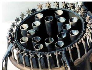
Figura 2 – Mostra os tubos internos Steam Assited Flare
